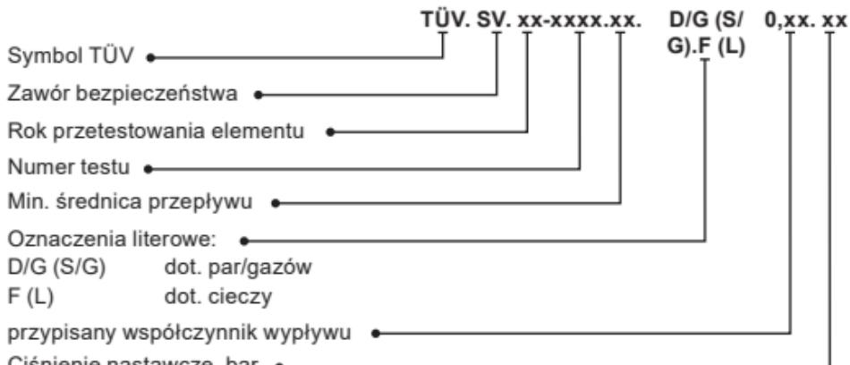
Zawory bezpieczeństwa są testowane przez nas pod kątem odporności na ciśnienie i szczelności, dostosowywane do żądanego ciśnienia nastawczego i plombowane. Oznakowanie umieszczane jest w sposób trwały na tabliczce znamionowej lub kołpaku sprężyny. Ponadto oznakowanie zawiera niezbędne informacje zgodne z normą DIN EN ISO 4126-1.
