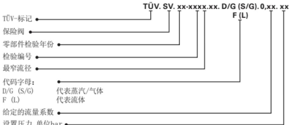
出厂前，所有安全阀通过了抗压强度试验和密封性试验，按客户需求调试好了设置压力并予以铅封。产品铭牌或者阀门的弹簧腔阀盖上印有永久性标识。
