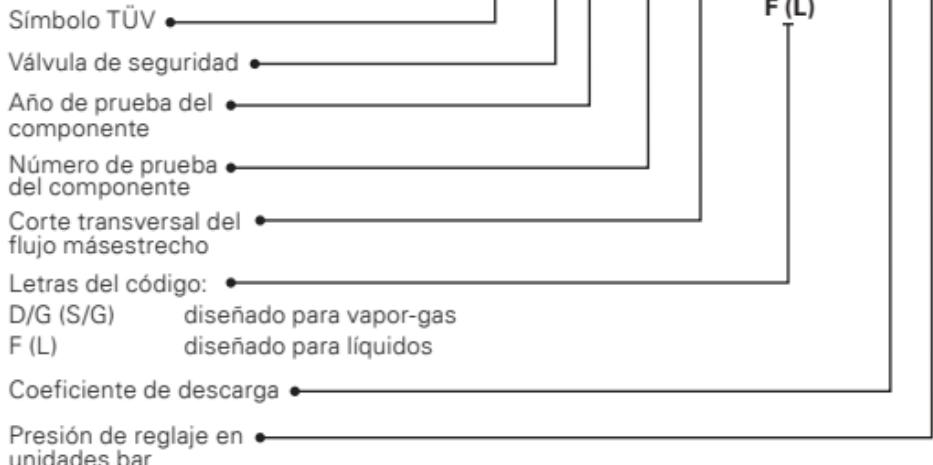
Revisamos las válvulas de seguridad para comprobar la resistencia a la presión y la estanqueidad, ajustamos la presión de reglaje requerida y las sellamos.
