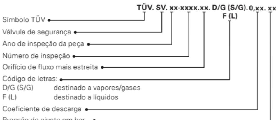
As válvulas de segurança são testadas por nós para resistência à pressão e estanqueidade, ajustadas à pressão de ajuste desejada e vedadas. A identificação está marcada de maneira indelével na placa de identificação ou no castelo da válvula. Além disso, a identificação contém as informações necessárias de acordo com a DIN EN ISO 4126-1.
