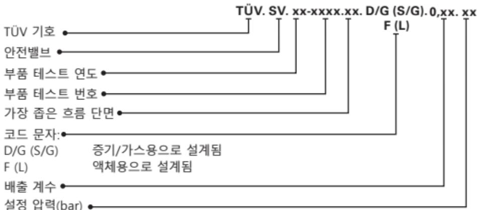
압력 저항 및 기밀성에 대해 안전밸브를 확인하고 요청된 설정 압력을 조정하여 밀봉합니다. 영구 마킹 시스템을 이용해 타입 플레이트 또는 벨브의 스프링 보닛에 식별 ID를 적용합니다. 또한 DIN EN ISO 4126-1에 따라 마킹 및 기술자료가 식별 플레이트에 포함됩니다.
