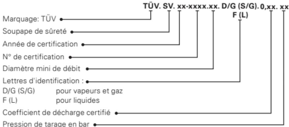
Nos soupapes de sécurité sont contrôlées quant à leur résistance à la pression et à leur étanchéité; elles sont réglées à la pression de tarage souhaitée et dotées d'un plombage. Le marquage est indiqué de façon indélébile sur une plaquette attachée à chaque appareil, ou sur le chapeau à ressort de la soupape. Sur la plaquette d'identification figurent de plus des marquages et informations techniques requises suivant la DIN EN ISO 4126-1.
