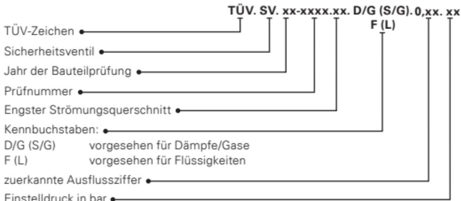
Sicherheitsventile werden von uns auf Druckfestigkeit und Dichtheit geprüft, auf den gewünschten Einstelldruck einjustiert und plombiert. Die Kennzeichnung erfolgt unauslöschlich auf dem Typenschild, bzw. auf der Federhaube des Ventils. Zusätzlich enthält die Kennzeichnung die notwendigen Angaben gemäß DIN EN ISO 4126-1.
