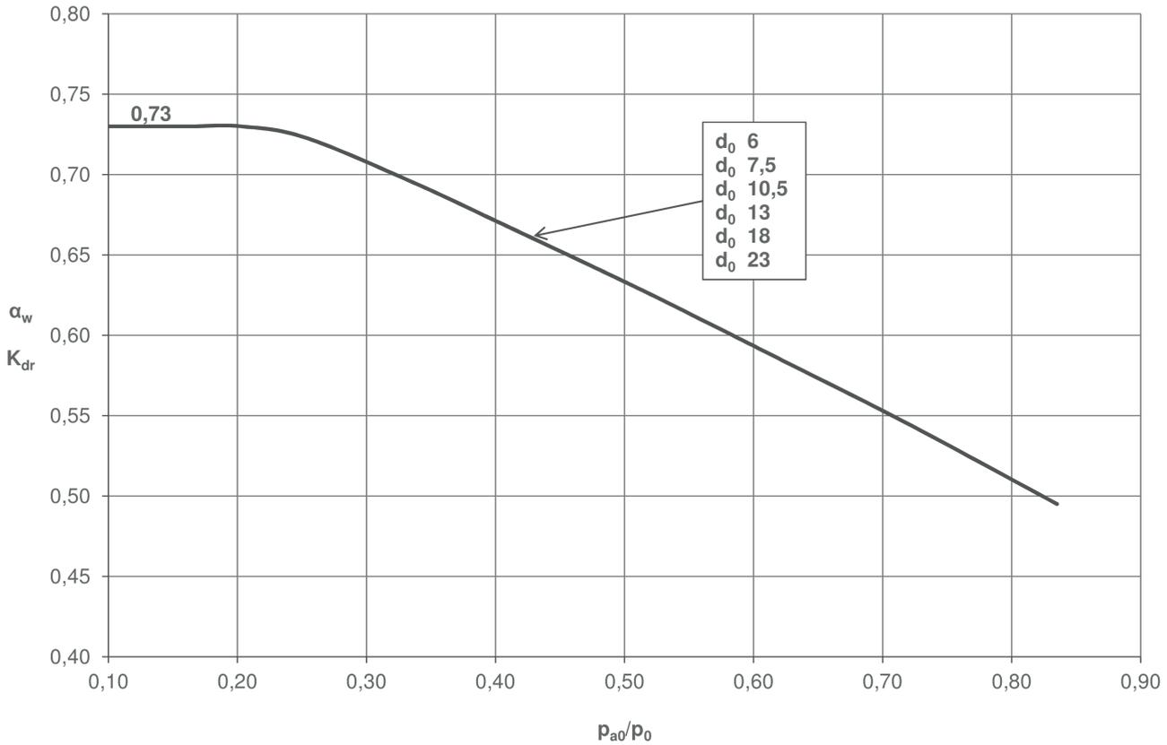
$$\frac{p_{a0}}{p_0} = \frac{\text{Противодавление (бар абс.)}}{\text{Давления сброса (бар абс.)}} \quad p_{atm} = \text{Атмосферное давление} = 1,01325 \text{ бар абс.}$$
